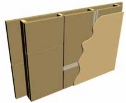
Lehmbauplatten als Trockenbauplatten
