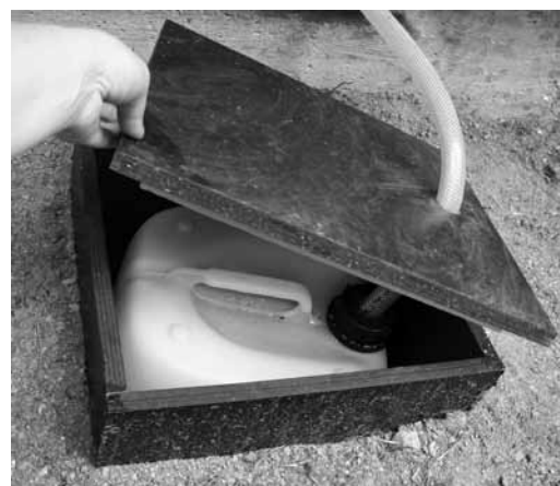
Abb. 3: Sammelbehälter für Sickerflüssigkeit
